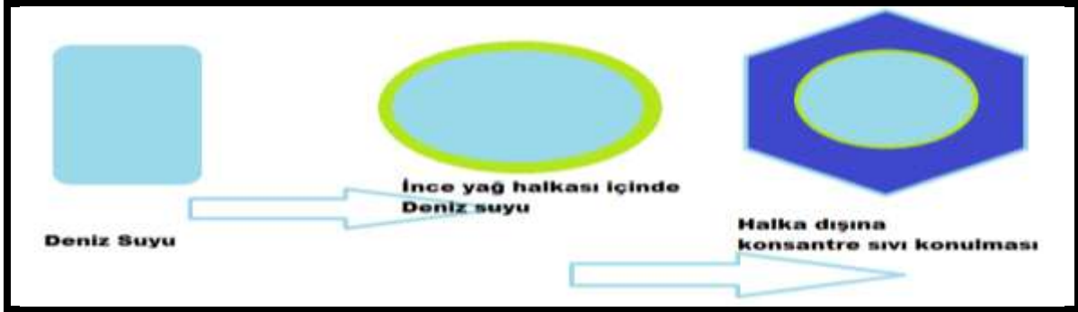
Şekil 3-1a: Deniz suyunun serbest, ince yağ halkası ile çevrilmesi ve dışarıya konsantre sıvı
