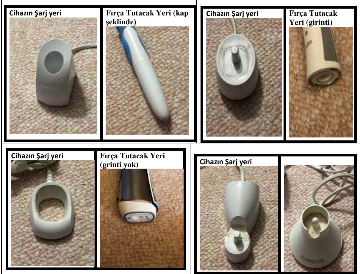
Şekil 2/b: Şarj yeri ile cihazın girişi birbirine uyumlu olmalıdır
